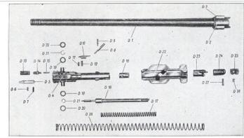
MG 34, Einzelteile: Lauf mit Verschluss
