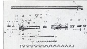
MG 34, Ersatzteile: Lauf mit Verschluß
