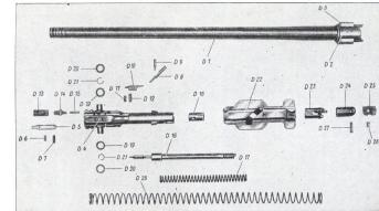
MG 34, Ersatzteile: Lauf mit Verschluß
