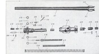
MG 34, Einzelteile: Lauf mit Verschlußkopf
