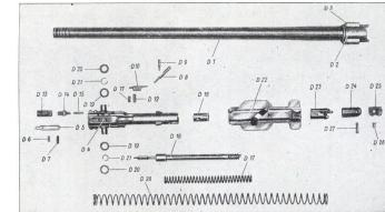
MG 34, Ersatzteile: Lauf mit Verschluß
